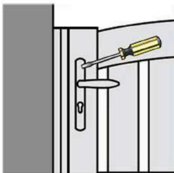
2- Mettre la poignée en place et la serrer à l'aide d'un tournevis.
