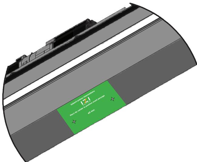
2. Percer la poutre aux endroits indiqués avec un foret de  $\varnothing 3\text{mm}$ . **Puis retirer l'autocollant et ébavurer.**
