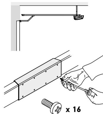
• Fixer l'ensemble à l'aide des vis de fixation.
