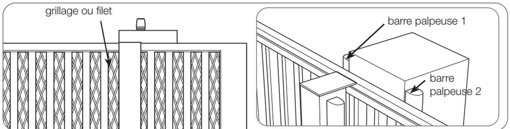
La barre palpouse 2 est nécessaire si le pilier et le muret (ou clôture) ne sont pas alignés (comme sur le schéma) créant ainsi une zone d'écrasement entre le bord du pilier et un barreau du portail (les barres palpouses utilisées doivent avoir une déformation suffisante entre le déclenchement et la position où le portail s'arrête effectivement (6 cm) (course résiduelle d'après la figure 3 de la EN 12978).
