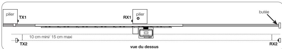
En branchant les photocellules de cette manière, le système réagit à une coupure de l'un ou l'autre des faisceaux infrarouge pendant la fermeture, et du faisceau bord secondaire en ouverture.
